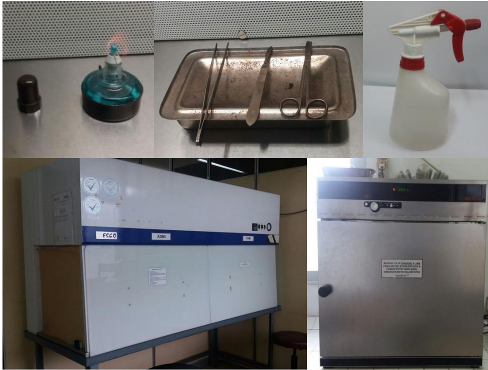
Gambar 3.6. Beberapa peralatan pada ruang penanaman (A) Bunsen burner(B) Alat-alat diseksi (C) Hand sprayer untuk alcohol (D) Laminar air flow cabinet(E) Oven
