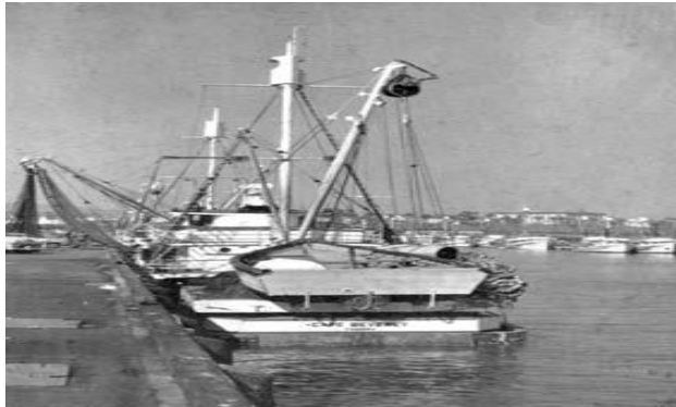
Gambar 28. Power Block Pada Kapal Purse Seine.
