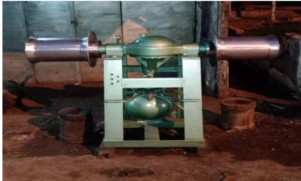
Gambar 27. Power Block Dari Modifikasi Gardan Mobil.
