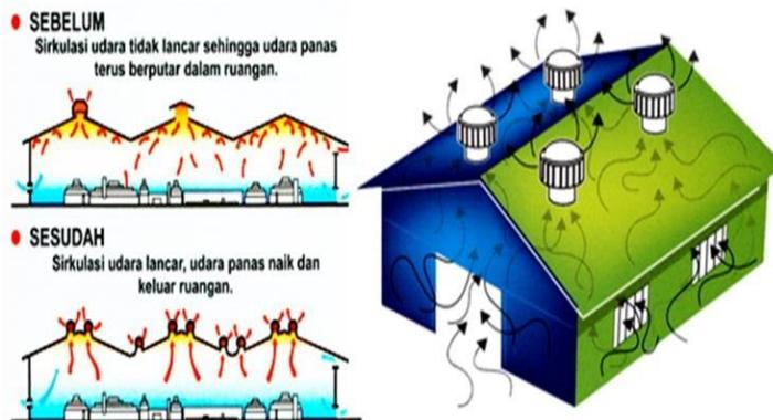
Gambar 2.6 Sistem sirkulasi udara pada turbin ventilator
