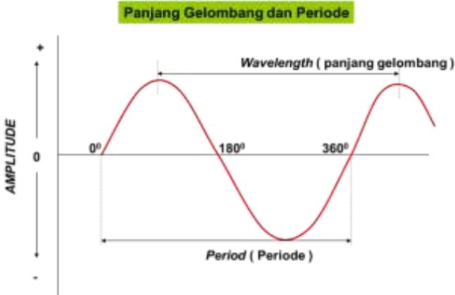
Gambar 269: Ilustrasi panjang gelombang pulsa radar.
