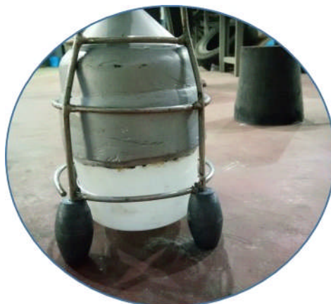
Gambar.6 : lampu hasil pengecoran dan rangka pelindung beserta pemberat
