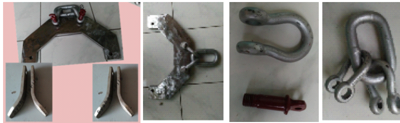
Gambar 16. Konstruksi plat penggantung kelos takal dan penyediaan 2 jenis zackle
