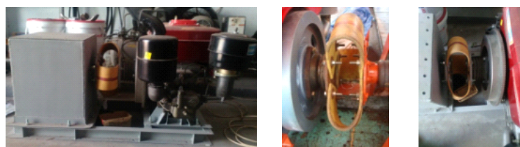
Gambar 10. Penyambungan Kotak Pompa terhadap Diesel Penggerak Konstruksi
