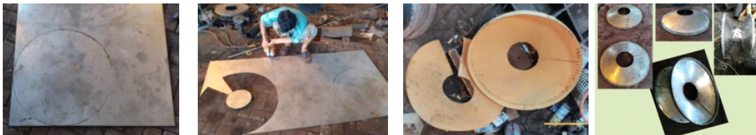
Gambar 12. Proses pembuatan konstruksi kelos takal ( power block )
