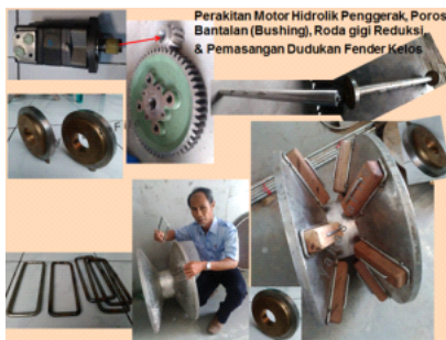
Gambar 20. Perakitan kelos power block
