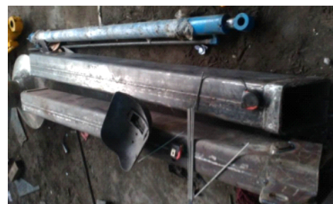
Gambar 18. Hasil pembuatan konstruksi balok penjulur
