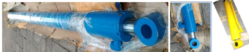
Gambar 17. Hasil pembuatan konstruksi 2 jenis syinder hydraulic
