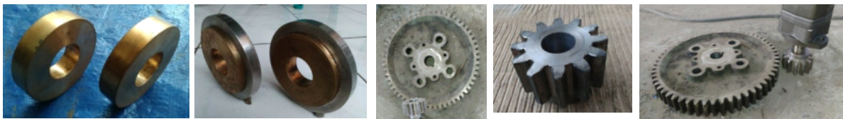
Gambar 13. Pembuatan bushing bronzze , cincin stainless pengikat bushing dan pembuatan poros, serta roda gigi besar dan kecil
