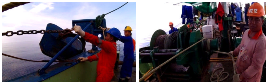
Gambar 6. Penaikkan Otter Board (kiri) dan menarik Lazy Line (kanan) pada saat Houling
