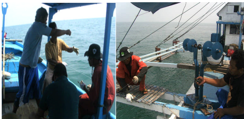
Gambar 3. Penarikan Rawai dengan Manual (tangan) dan Penarikan Rawai dengan Alat Penarik Rawai.
