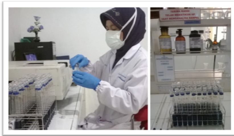
Gambar 1. Kegiatan pengujian konsentrasi fosfat di laboratorium uji BPPBAP dengan alat spektrofotometer UV-Vis
