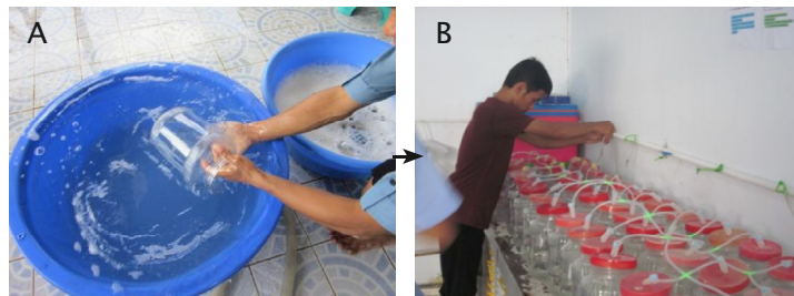
Gambar 2. Penyiapan wadah penelitian (A = pencucian stoples, B = pemberian aerasi)
