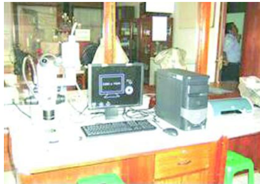
Gambar 2. Seperangkat mikroskop Nikon SMZ 1000 yang dilengkapi kamera Nikon DXM 1200 F dan program ACT-1.
