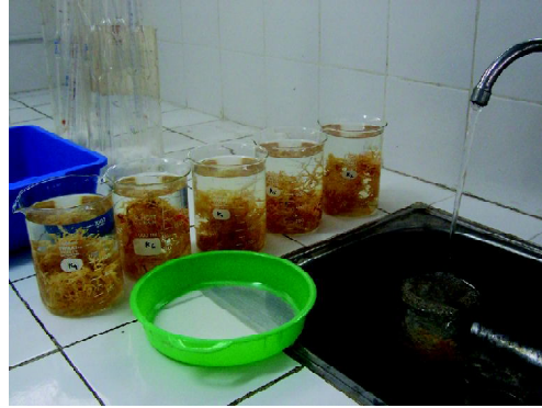
Gambar 2. Pencucian ekstrak dengan KOH 8% (1:6) selama \pm 3 jam di water bath 60°C—70°C
