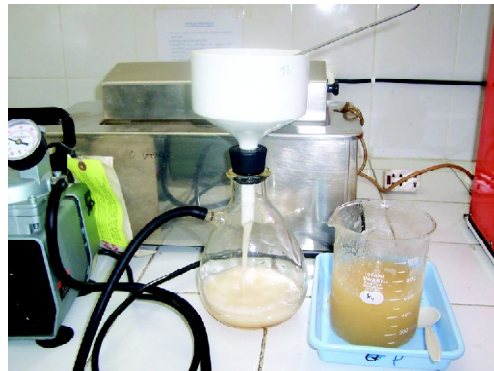
Gambar 4. Disaring dengan plankton net 200 mesh dan divakum
