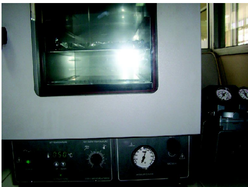
Gambar 5. Proses pengeringan dengan oven vakum
