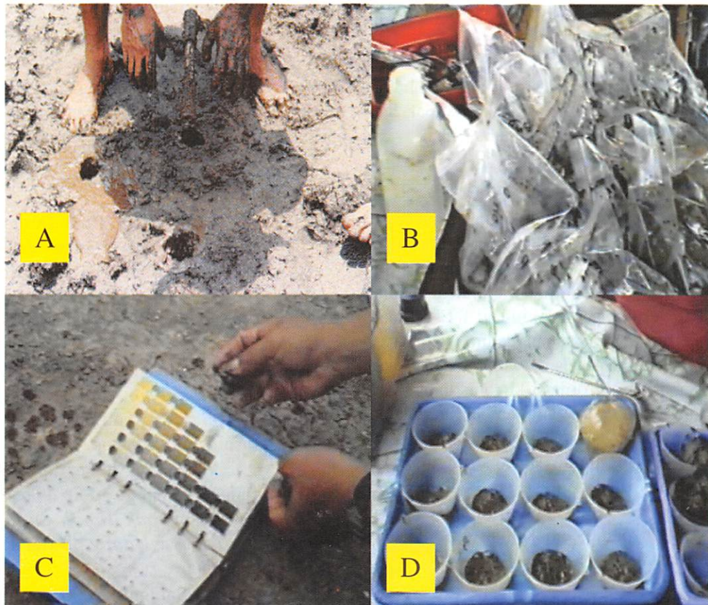
Gambar 5. Sampling tanah pada pelataran tambak (A= pengeboran tanah, B= sampel tanah yang dimasukkan ke dalam kantong kedap udara, C= penentuan warna tanah dengan munsell color chart , dan D= tingkat reaksi dengan peroksida)
