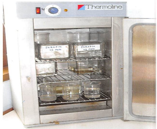
Gambar 4. Panaskan parafin dalam oven dalam suhu 60°C
