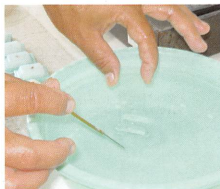
Gambar 8. Pengambilan irisan, ditempelkan pada gelas objek
