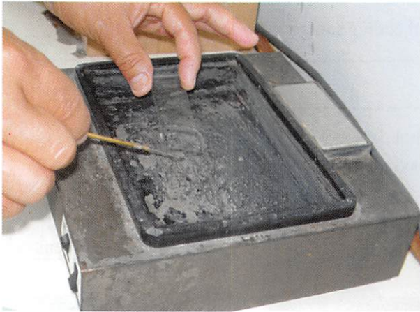
Gambar 9. Irisan sampel dicelupkan ke dalam water bath agar mengembang
