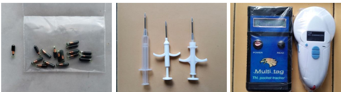
Gambar 1. PIT (Passive Integrated Transponder) tag (A), alat injektor ( implanter ) untuk memasang PIT tag (B), dan alat pembaca PIT tag ( PIT tag reader ) (C).
