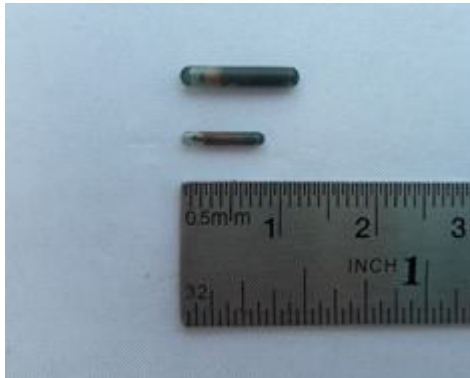
Gambar 1. Jenis penanda PIT (passive integrated transponder) tag yang berukuran paling besar (atas) dan paling kecil (bawah).
