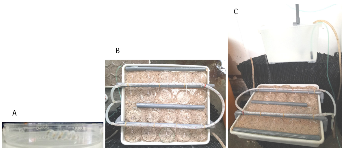
Gambar 1. Desain pemeliharaan lintah dengan sistem air mengalir. A). cawan petri plastik yang dilubangi. B). cawan petri plastik yang ditempatkan di atas pasir dalam nampan. Cawan petri dijejerkan di samping kanan dan kiri selang yang dilubangi dengan jarum suntik. C). Sambungan selang yang melingkar di atas nampan ke bak plastik yang diberi kucuran air laut secara terus-menerus.
