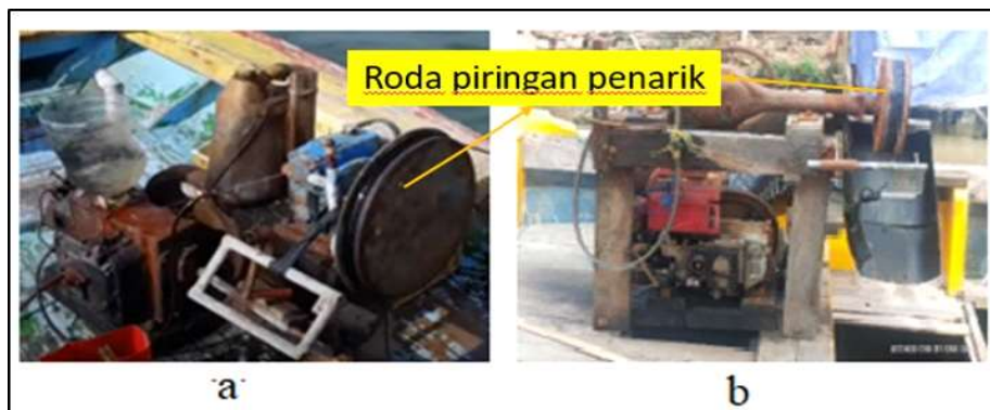
Gambar 4. Roda piringan penarik pada alat bantu penarik bubu rajungan dengan ukuran diameter (a) 50 cm, dan (b) 17 cm.
