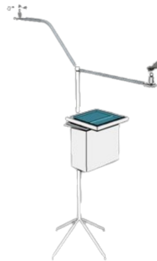
Gambar 1. Desain Stasiun Pengukur Kecepatan dan Arah Angin
