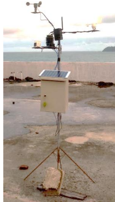
Gambar 2. Prototipe Stasiun Pengukur Kecepatan dan Arah Angin
