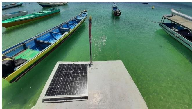
Gambar 1. Pemasangan PLTS di Kapal Nelayan
