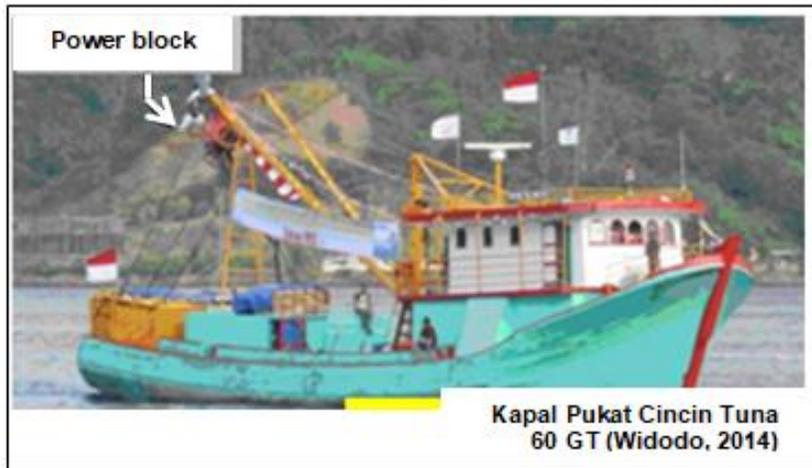
**Gambar 7.1.** Kapal pukat cincin tuna tipe penangkap (*catcher boat*) berbahan kayu berukuran 60 GT yang dioperasikan di WPPNRI 717.
