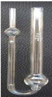
**Gambar 22. Viskometer
