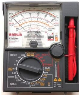
Gambar 20. Multimeter
