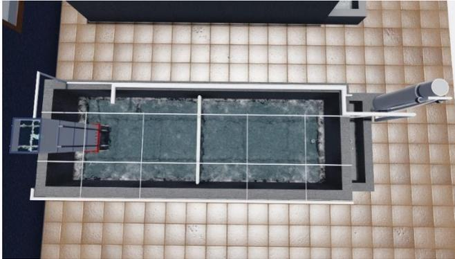
**Gambar XI.3.** Desain sistem resirkulasi untuk pemeliharaan benih lobster dengan filter dan unit *protein skimmer* (Sumber: Prama, 2017).
