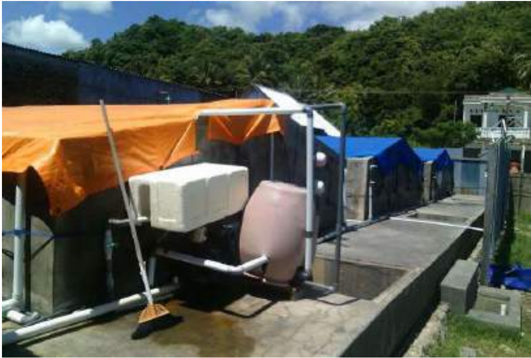
Gambar 139. Desain dan penggunaan teknologi water treatment dan aerasi minimal dalam HRST (Photo Credit: BBRPBLPP Gondol)
