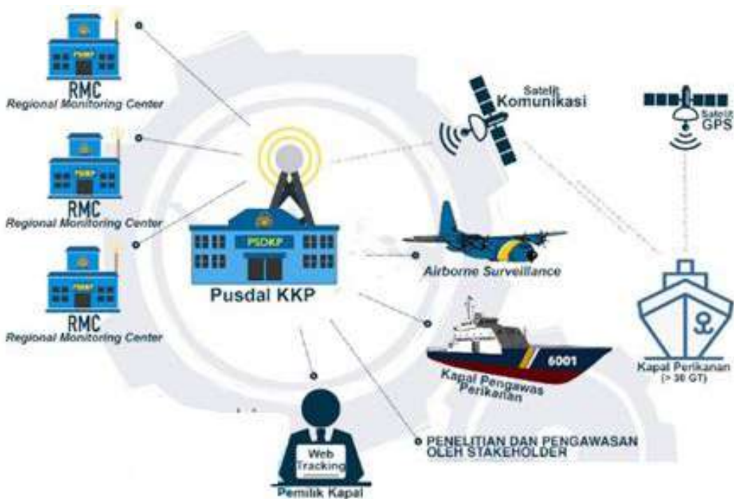
Gambar 114. Penggunaan Vessel Monitoring System pada KKP (Disarikan dari Satgas 115)
