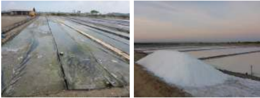
Gambar 30. Produksi garam dengan aplikasi geomembran (HDPE): Pra produksi, geomembran telah terpasang selama 1 tahun (kiri), produksi garam hasil aplikasi geomembran pada tahun kedua (kanan)
