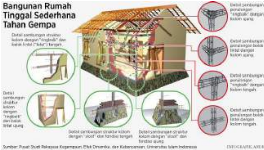
Gambar 54. Bangunan rumah tinggal sederhana tahan gempa (barrataga)
