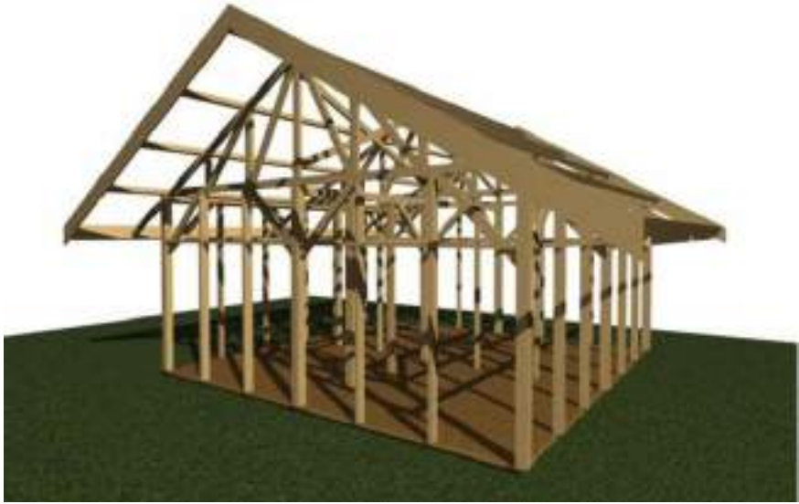
Gambar 56. Rumah instan kayu (Rika) yang konstruksinya terbuat dari kayu dirancang untuk tahan gempa.
