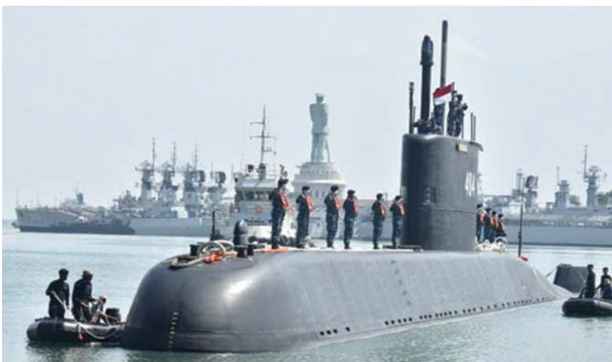
Gambar 14. Kapal-kapal perang TNI-AL di Dermaga Ujung, Surabaya. Kapal selam KRI Ardadedali 404 merupakan salah satu dari 3 kapal selam produksi Korea Selatan. Jarak jelajahnya 18.520 km, panjang kapal 61,3m, diameter 6,2m, kecepatan di bawah air 21 knot, kecepatan di permukaan 12 knot, dan mampu menyelam selama 50 hari serta kapasitas kru 40 orang. (Photo credit: Koarmada II).
