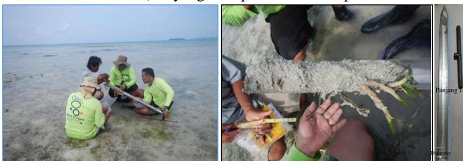
**Gambar 2.** Pengambilan sampel sedimen menggunakan *sediment core* (sumber: Kelti Blue Carbon P3SDLP, 2015)
