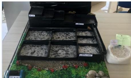
**Gambar 21. Produksi garam menggunakan geomembran**
