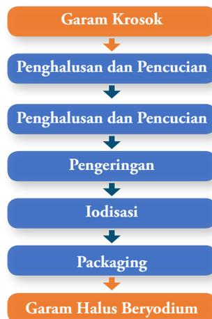
Gambar 25. Proses produksi garam
