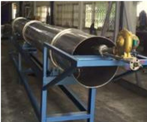
**Gambar 28. Mesin pengering berputar (Rotary drier)**
