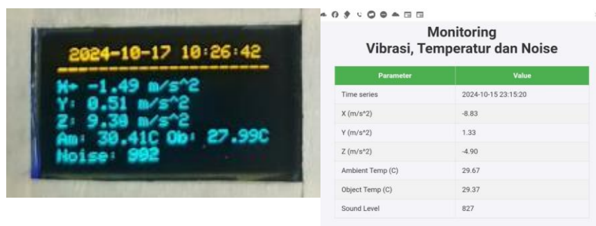
Gambar 5. Tampilan Hasil Pengukuran Pada Display OLED dan Mobile Device.
