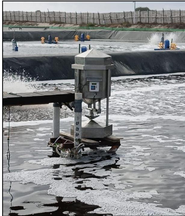
Gambar 5. ASF Berbasis IoT dan Energi Surya di Tambak Udang PT. Mina Balong Berkah.
