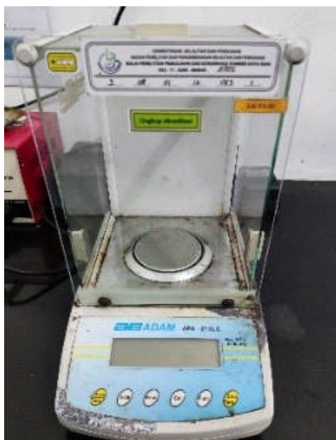
Gambar 1. Neraca analitik 4 desimal merek ADAM tipe AFA-210LC.
