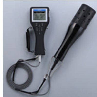
Gambar 2. Water Quality Checker Multi Parameter Horiba Serie U50
