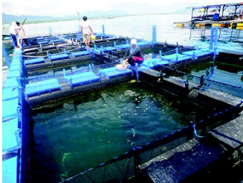
Gambar 1. Keramba HDPE Aquatec ukuran petakan 3 m x 3 m dengan konfigurasi E-12 (6 x 2) petak
