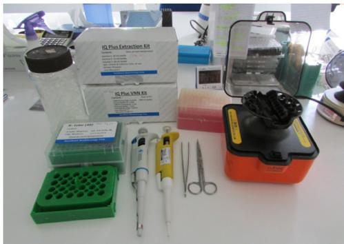
Gambar 1. Bahan kimia dan alat untuk ekstraksi virus VNN dengan metode IQ Plus
