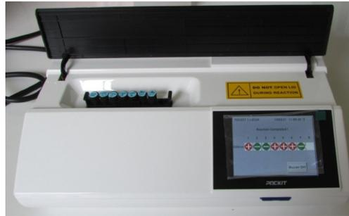
Gambar 2. Alat yang dipakai untuk amplifikasi dan dokumentasi (PCR POCKIT)
