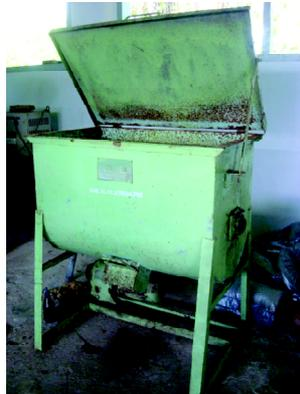
Gambar 3. Alat untuk mengaduk campuran bahan pakan dengan kapasitas 100 kg
