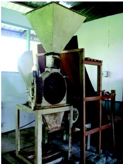
Gambar 1. Alat untuk menghaluskan bahan kering
