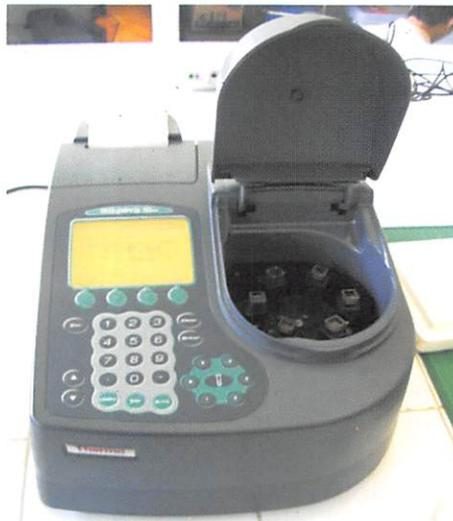
Gambar 5. Dibaca pada spektrofotometer dengan panjang gelombang 400 nm
