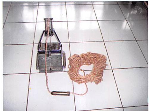
Gambar 2. Alat Eijkman Grab untuk mengambil sampel sedimen
