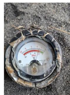
Gambar 10. Pengukuran pH Pasir
