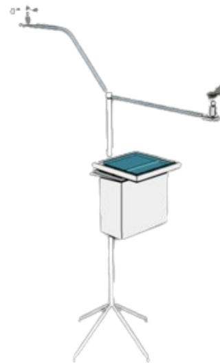
Gambar 1. Desain Stasiun Pengukur Kecepatan dan Arah Angin
