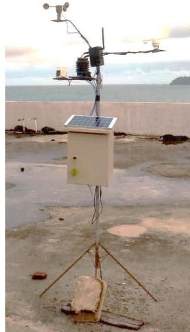
Gambar 2. Prototipe Stasiun Pengukur Kecepatan dan Arah Angin
