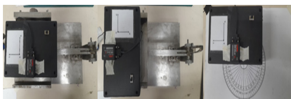
Gambar 3 Pengaturan kalibrasi statis: Roll (kiri), Pitch (tengah) dan Yaw (kanan)
