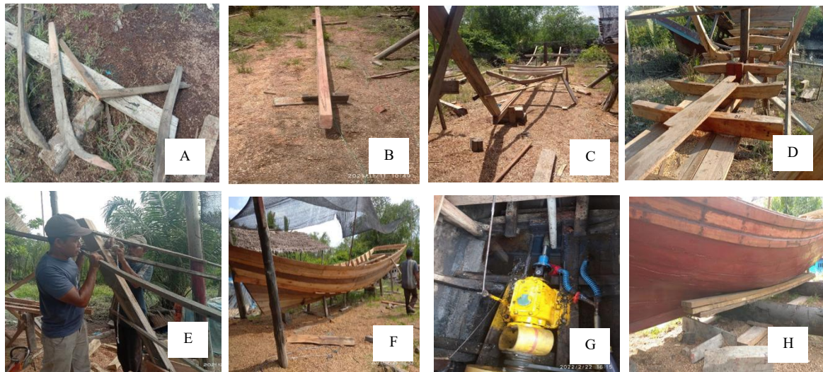
(A.) Pembentukan gading-gading (B.) Peletakan lunas (C.) Peletakan wrang dan lajur wrang (D.) Pemasangan wrang (E.) Pemasangan jalur acuan gading (F.) Pemasnagan kulit lambung (G.) Pemasangan mesin (H.) Peluncuran.
