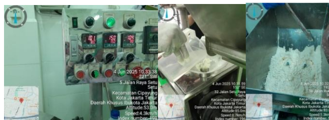
Gambar 2. Proses pencetakan becal pada alat ekstruder
