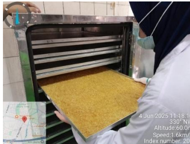
Gambar 3. Pengeringan becal menggunakan oven
