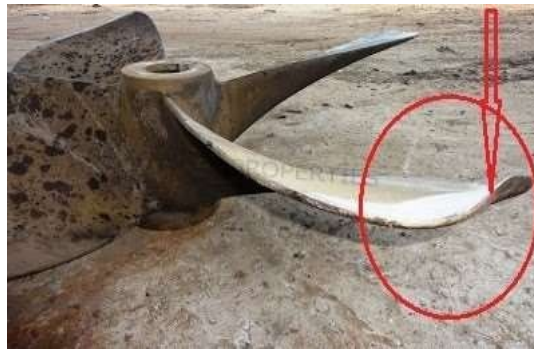
Gambar 2. Daun Baling-baling yang mengalami kebengkokan
