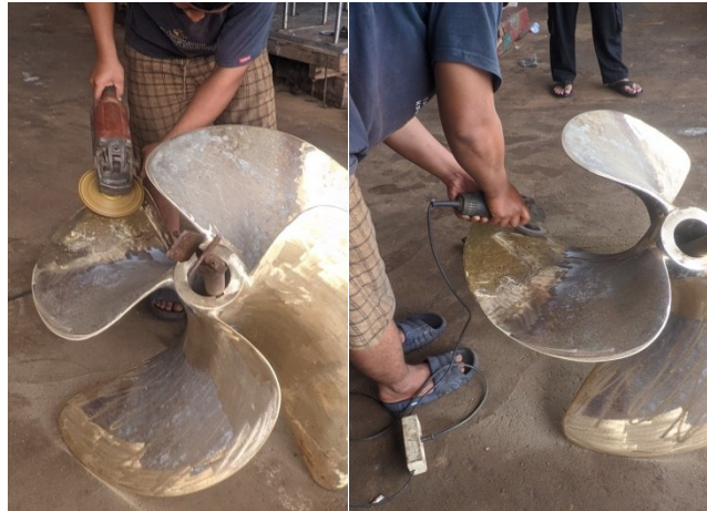
Gambar 4. Proses penghalusan daun baling-baling menggunakan gerinda tangan
