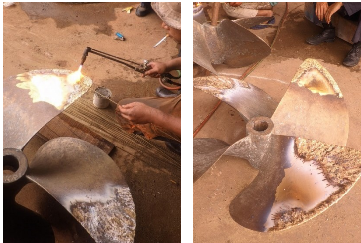
Gambar 3. Proses pengelasan dan hasil pengelasan daun baling-baling
